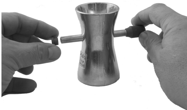
Фото 3. Установка трубки и ограничительного кольца.
