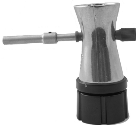
Фото 1. Регулируемая платформа – в верхнем положении. (Угол наклона раздаточной трубки увеличивает скорость подачи пороха).
