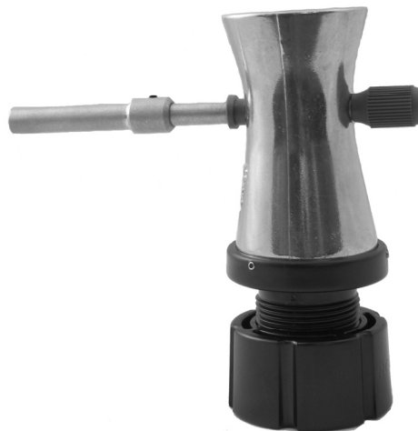
Фото 1. Регулируемая платформа – в верхнем положении. (Угол наклона раздаточной трубки увеличивает скорость подачи пороха).
