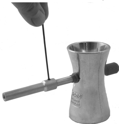
Фото 4. Установка удлиняющей трубки.
